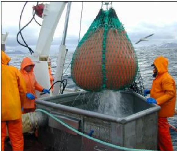
Bilde 25: Sekk løftes om bord, fylt med vann og fisk. Legg merke til hvordan lerretsløftet er festet under/bak løftestroppa. Sekkeknuten åpnes og fisken slippes ned i sorteringskaret.
